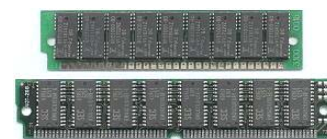
SIMM-Module in der 30- und 72-poligen Ausführung mit Datenbreiten von 8 und 32 Bit.
