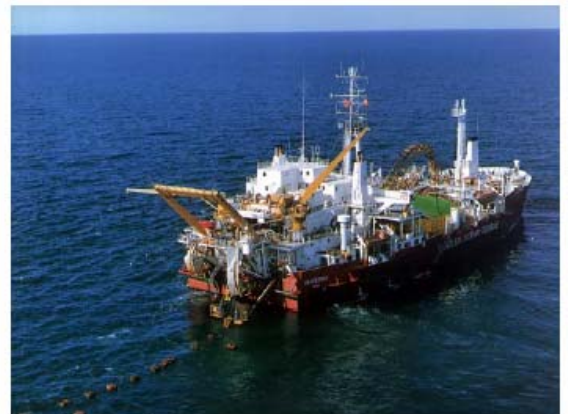
Kabelverlegegeschwindigkeit bis zu 15 km/h in Tiefen bis 7000 m. Das Füllen eines Schiffes mit Kabel dauert i.a. mehrere Wochen.
