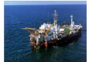
Kabelverlegegeschwindigkeit bis zu 15 km/h in Tiefen bis 7000 m. Das Füllen eines Schiffes mit Kabel dauert i.a. mehrere Wochen.
