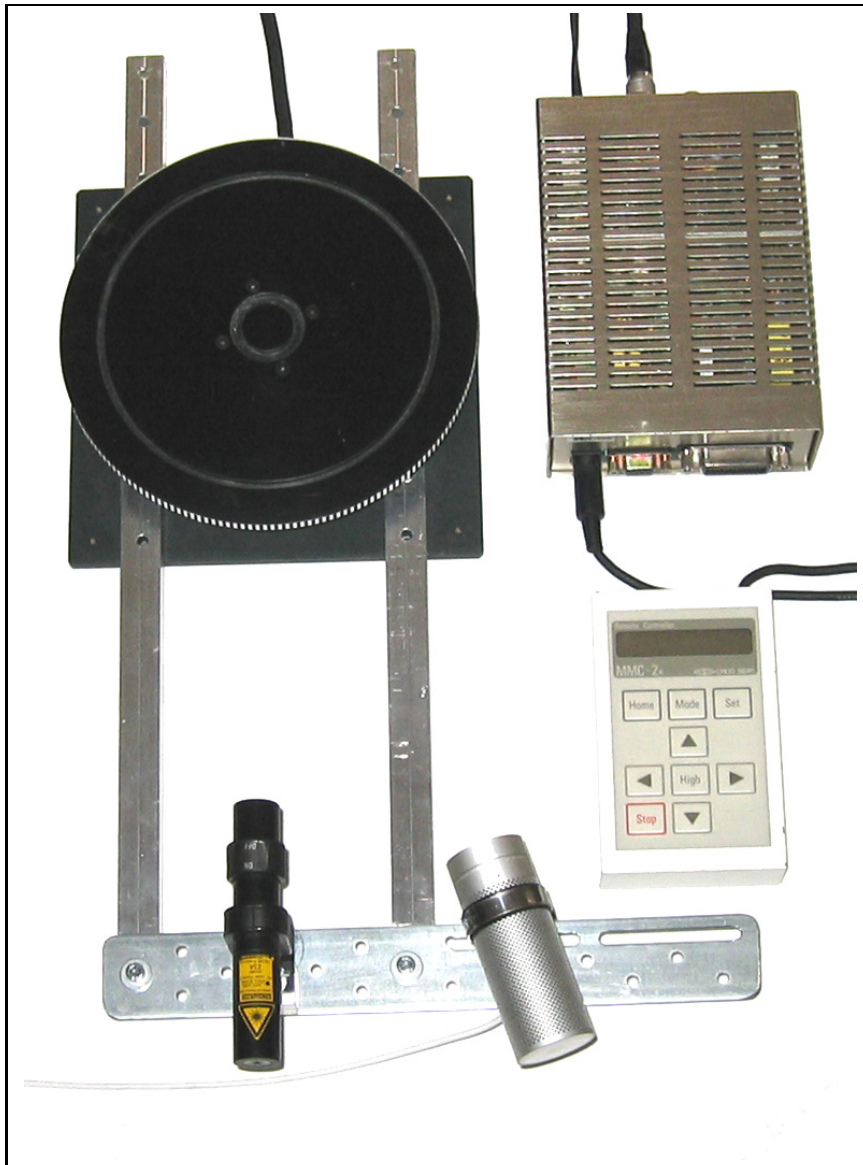
Abbildung 9: Laserscanner, bestehend aus Drehteller, Laser (u. links), Kamera (u. rechts) und Steuerungseinheit mit Benutzerschnittstelle (rechts)
