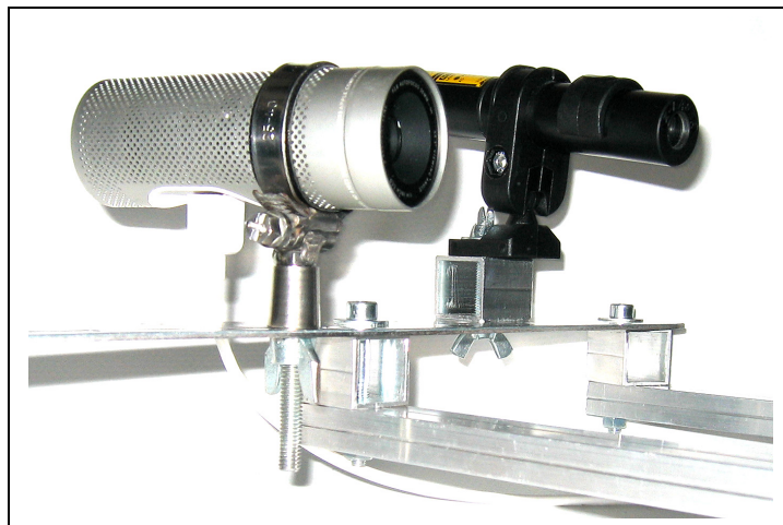
Abbildung 8: Montage von Laser und Kamera mit Standfüssen
